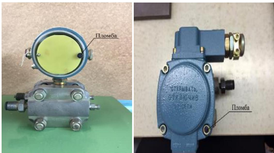
Рисунок 3 - Место нанесения пломбы
