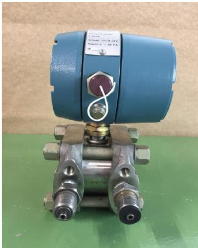
Рисунок 1 - Общий вид преобразователей измерительных Сапфир 22М и Сапфир-22-Ех-М
